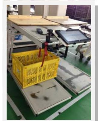
牽引車でのピッキング事例です。牽引車についたタブレットにピッキング指示が表示されます。商品のバーコードをスキャンして正しければ台車のそれぞれの表示器に仕分する数量がランプの点滅と同時に表示されます。
